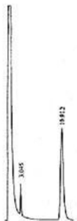
图A 标准品气相色谱图 图中 tr=0.588 溶剂， tr=3.045 大蒜辣素 tr=11.011 大蒜素
