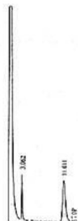
图B 片剂试样气相色谱图 图中 tr=0.6 溶剂， tr=3.062 大蒜辣素 tr=10.912大蒜素
